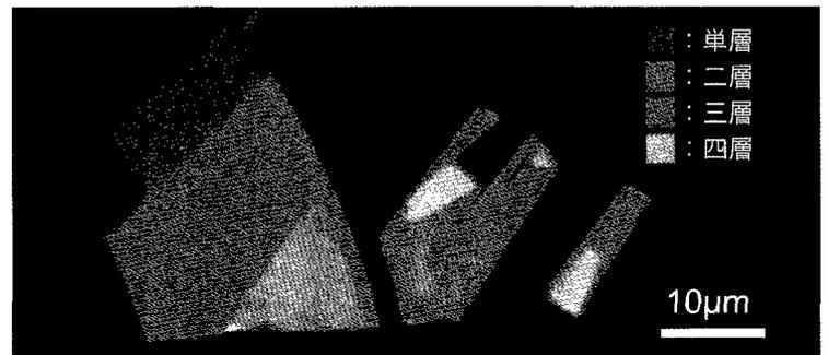
熱酸化したシリコン基板に分布するグラフェン薄膜のラマンイメージ。炭素 1 原子のシートである単層グラフェンと、二層、三層、四層の多層グラフェンが、それぞれどのように分布しているかを、わずか数分の測定時間と 350nm という高い空間分解能でイメージングしています。
