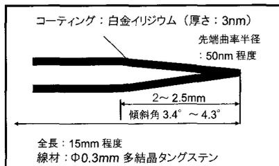
図：ナノプロービング用白金イリジウムコートナノプローブ UP-100P
